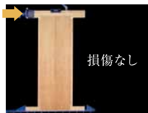
オリジナル耐力壁 損傷も無く、建物を守ります。
