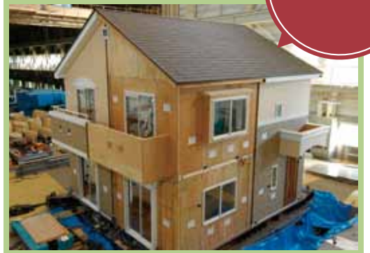
I.D.S工法の試験体 ※4
