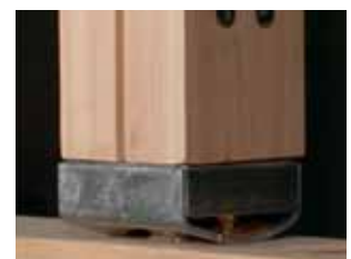
TロックII 金物が歪みはするが、柱は固定されたまま。
